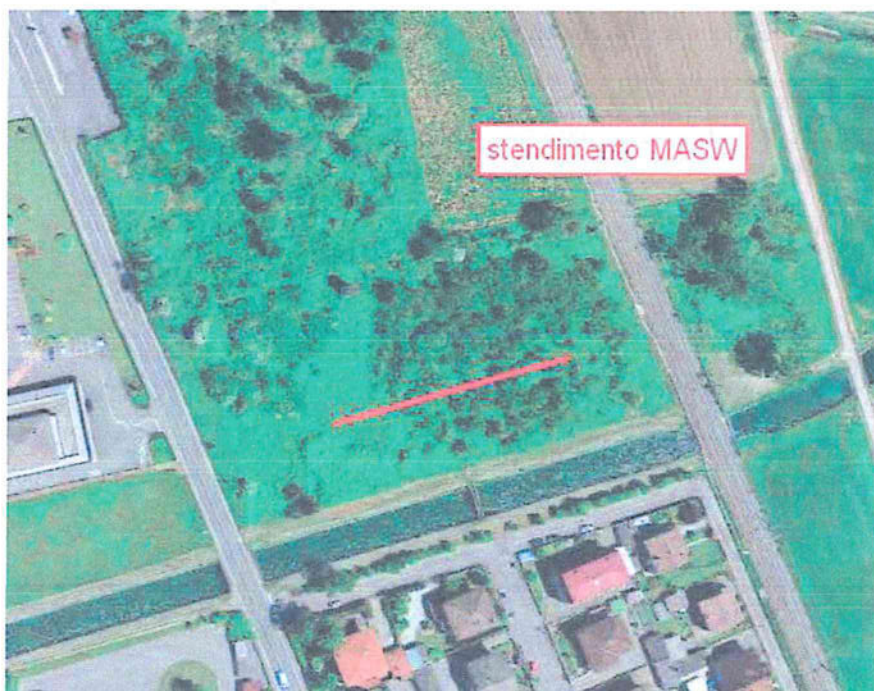
Ubicazione stendimento sismico
